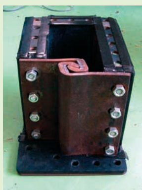
写真-15 継手のセット状態
