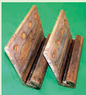
写真-14 パイルロック®NS-vを塗布した継手
