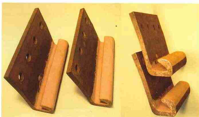
写真-11 パイルロックを塗布した継手
