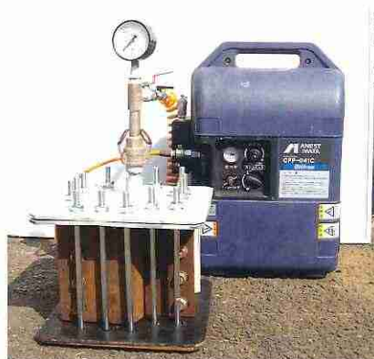
写真-12 止水圧試験システム
