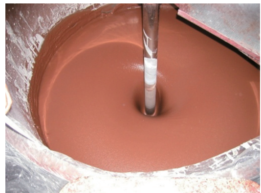
写真1 攪拌中の遮水性コーティング材
