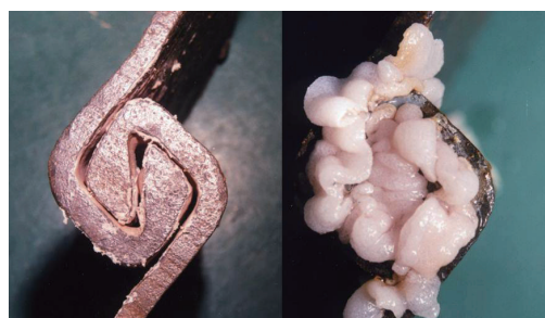
写真3 膨潤性止水材の膨潤前(左)と膨潤後(右)
