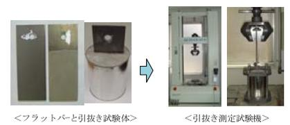
図 5 模擬仮設杭の引抜き試験の概要
