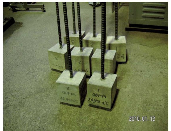
写真-2 付着強度試験被検体
