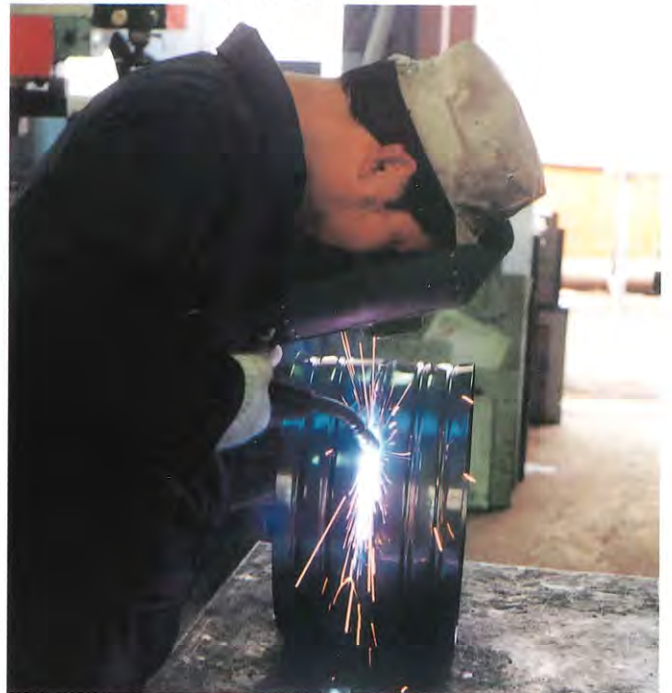
写真-2 ◆ 端板の溶接試験
