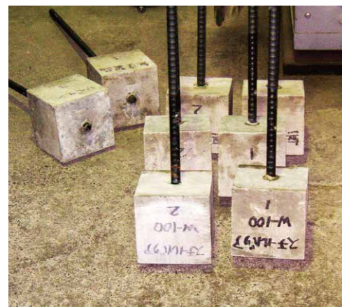
エポキシ樹脂塗装鉄筋の付着強度試験 (JSCE-E516-2003に準拠)
